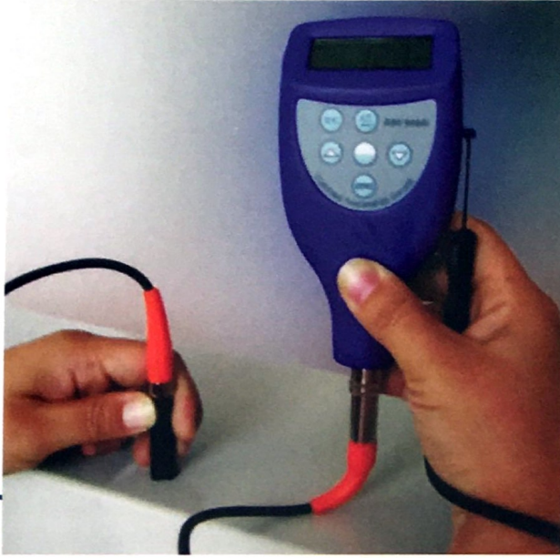
Şekil 2. Girdap Akım teknolojisi ile boya/kaplama film kalınlığı ölçümü
