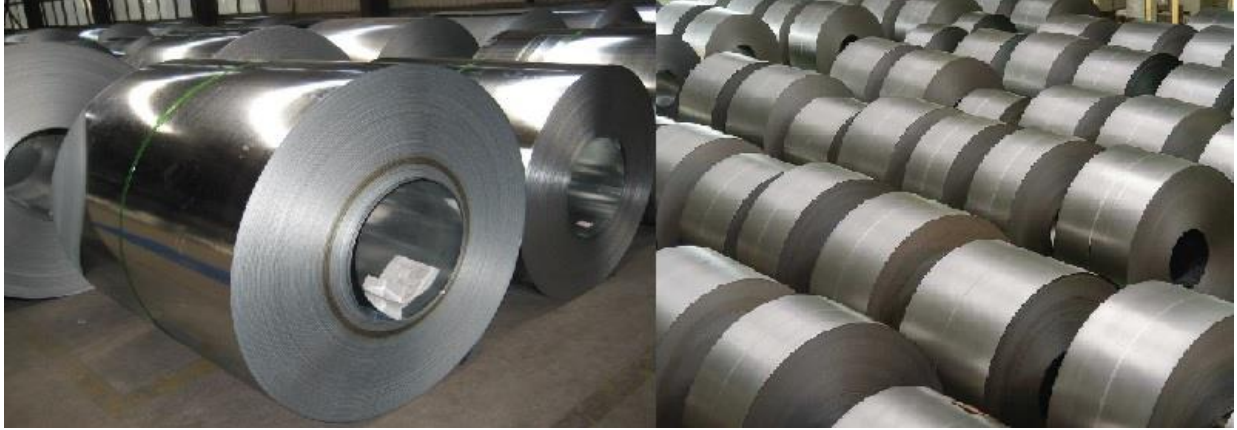
Resim 11: Sürekli Sıcak-Daldırma Galvanizleme işlemi sonra sevkiyat için ambalajlanmış rulo saclar
